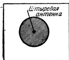
Рис. 28. Диаграмма направленности штыревой антенны
